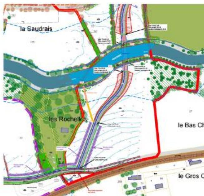
Figure 8 : tracé 3bis modifié retenu pour le franchissement du canal d'Ille-et-Rance (pièce 2, p.41)
