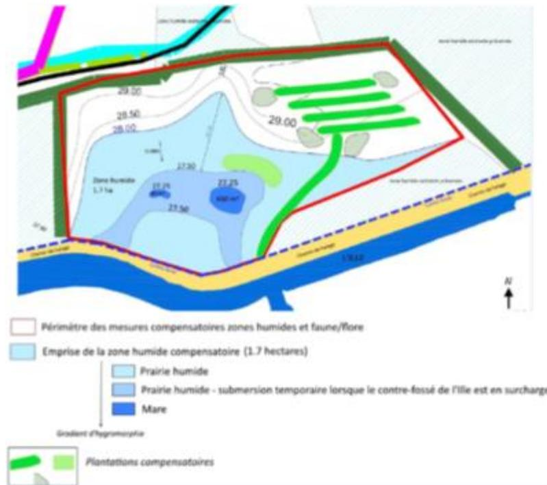
Figure 14 : représentation sur plan de la mesure compensatoire (source pièce 5, p.35)
