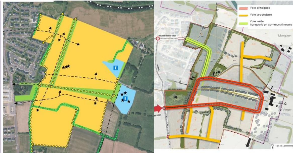
Figure 31 comparaison schéma de principe OAP/PLU et schéma retenu de circulation pour le projet
